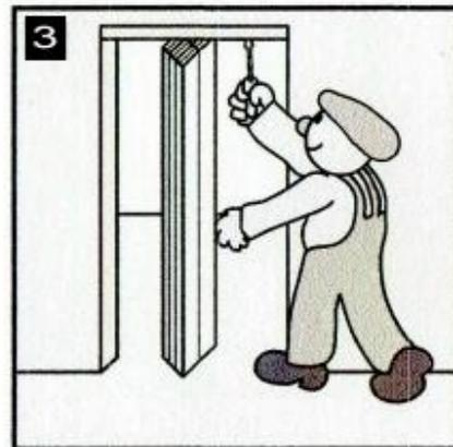
3 Riportare la guida di scorrimento in asse e fissare le altre due viti.
