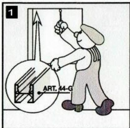
1 Fissare la guida di scorrimento solo con vite centrale, con il lato A rivolto verso il muro.
