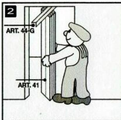
2 Ruotare di 90° la guida di scorrimento ed inserire il kit porta.
