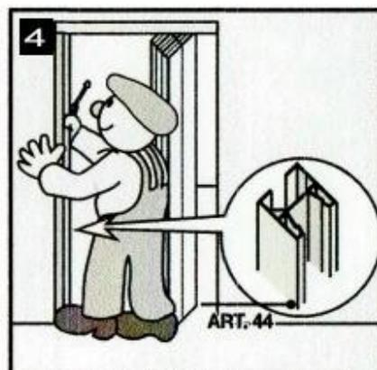
4 Fissare l'attacco laterale come partenza con il lato B rivolto verso il muro.
