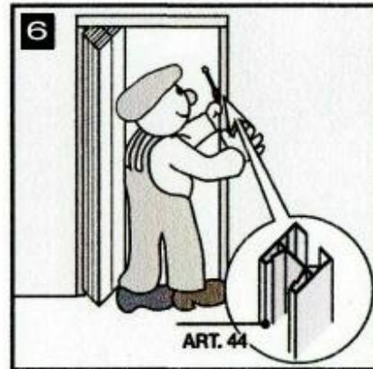
6 Fissare l'attacco laterale come arrivo con il lato B rivolto verso il muro.
