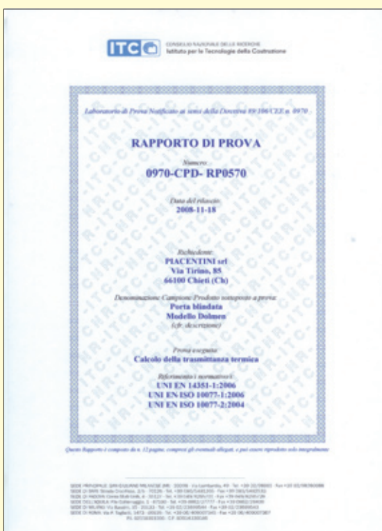
Trasmittanza termica 1,49 W/m²K.
