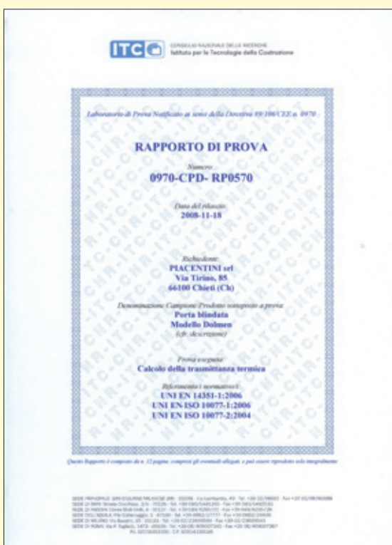
Trasmittanza termica 1,49 W/m²K.
