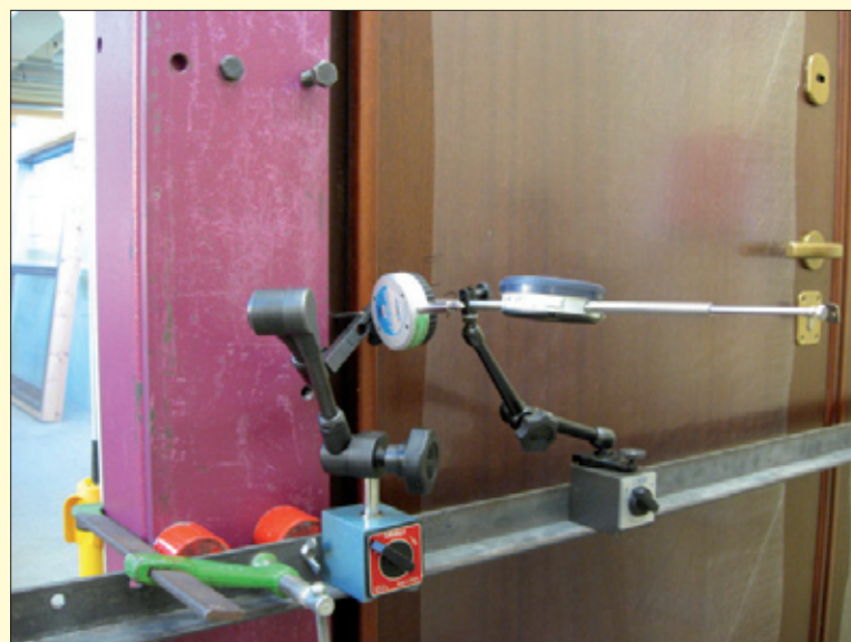
Antieffrazione: prova sotto carico statico.
